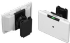
Infinite InforSense Vision은 선반에 진열된 제품의 재고 상태를 일정한 시간 간격으로 촬영된 이미지의 전/후 사진 비교를 통해 감지합니다. 재고 상태 및 품질 여부를 관리자에게 실시간으로 전달합니다.
